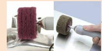
ソフトタッチで研磨ができ 加工物の形状に自在にフィットする 万能仕上げサンダーです。
