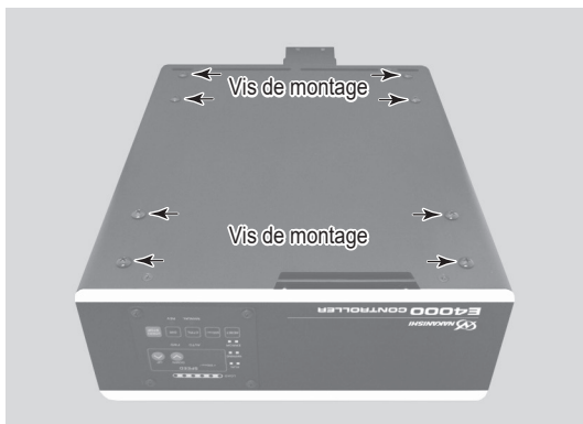
Vis de montage (8 pcs) fixées sur la surface inférieure du BOÎTIER DE CONTRÔLE .
