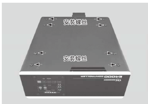
安装附着于控制器底部的螺丝（8个）。
